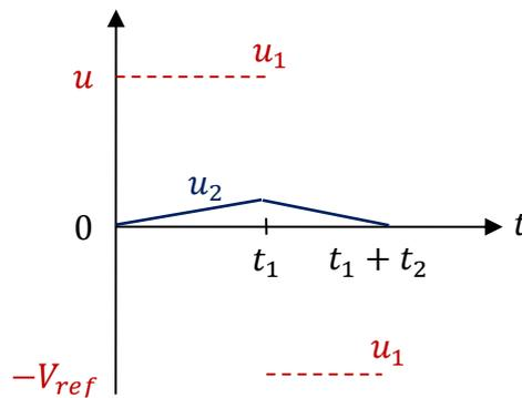
I.B.2.c) Le nombre  $s_N$  est la partie entière de  $\frac{t_2}{T_{ck}} \rightarrow s_N = \lfloor t_2 f_{ck} \rfloor = \left\lfloor (2^N - 1) \frac{u}{V_{ref}} \right\rfloor$
