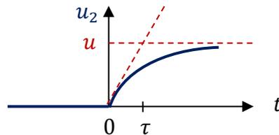
I.B.1)  $u_2(t) \sim u \left( 1 - \left( 1 - \frac{t}{\tau} \right) \right) = \frac{t}{\tau} u$  ( $u_1 \sim \tau \frac{du_2}{dt}$ ) Le bloc B est un pseudo **intégrateur**  $v_{sA} = 5 V$
