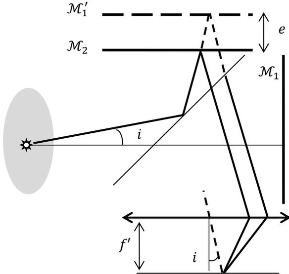
L'écran est dans le **plan focal** de la lentille, les miroirs sont perpendiculaires mais non symétriques par rapport à la séparatrice. L'interféromètre est équivalent à une lame d'air d'épaisseur  $e$  :  $\delta = 2e \cos i = \delta_0 \cos i$  (Privilégiez  $S'_1$  et  $S'_2$  tout en haut, hors figure, pour la démo)
