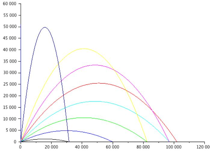
**Remarque :** la norme  $v_0$  du vecteur vitesse étant fixée, toutes les paraboles précédentes sont dans une zone du plan délimitée par ce qu'on appelle une *parabole de sécurité*. C'est cette parabole qui définit la zone « à l'abris des tirs ».
